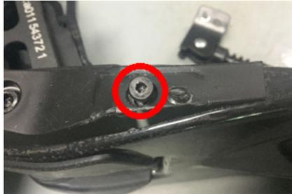
Posizionare il cavalletto sul telaio del monopattino avendo cura di allineare i due fori rispettivamente alla sede filettata della vite e alla sporgenza in plastica.
